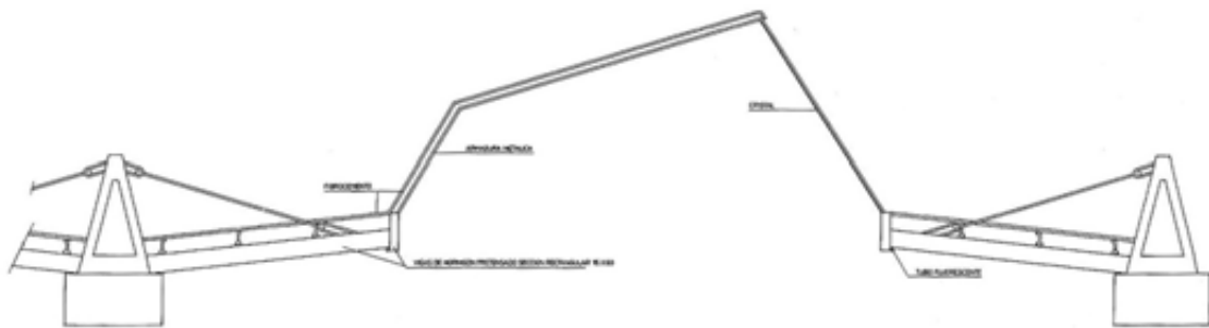
Figura A50. Estructura de voladizos y lucernarios. Fundación A. de la Sota.
